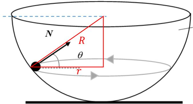
iv) Para que la pelota haga un movimiento circular uniforme con un radio igual al radio  $R$  del cuenco, el ángulo  $\theta$  debe ser nulo ( $r = R \cdot \cos\theta$ , si  $r = R \rightarrow \cos\theta = 1 \rightarrow \theta = 0^\circ$ ). La trayectoria coincidiría con el borde superior del cuenco.
