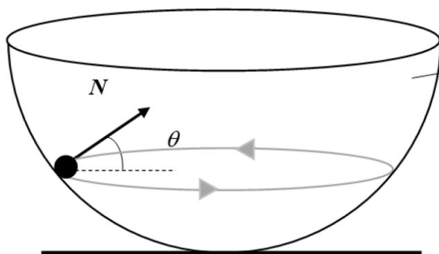
i) Al no existir rozamiento las dos únicas fuerzas que actúan son la gravitatoria y la normal, que es perpendicular a la superficie y apunta hacia el centro de la esfera.
