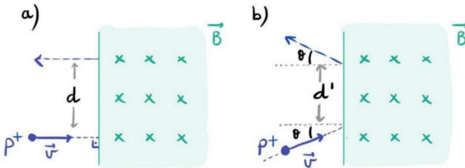
**i)** Los dos casos son similares. Una partícula cargada  $q$  que entra en una región en la que existe un campo magnético constante y uniforme con una velocidad que es perpendicular a la dirección del campo ( $\vec{v}$  en el plano del papel y  $\vec{B}$  perpendicular al plano del papel).
