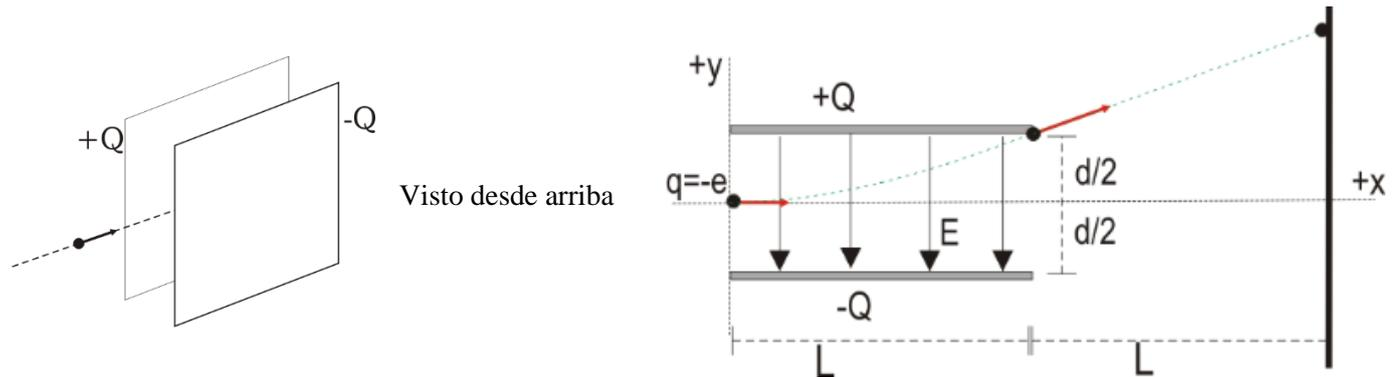
1. En un condensador de láminas planas la diferencia de potencial entre las placas viene dada por  $\Delta V = E \cdot d$  , siendo d la distancia entre las placas y E el campo eléctrico, que es constante y perpendicular a las placas.
