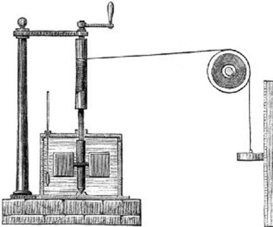
En este experimento, Joule conectó una serie de paletas en un contenedor de agua a una polea y una cuerda de la que colgaba un peso. Cuando este bajaba, la cuerda hacía girar el eje de las paletas, que rotaban en el agua. Más técnicamente, hacía descender una masa  $m$  una distancia  $h$ . La variación de energía potencial era de
