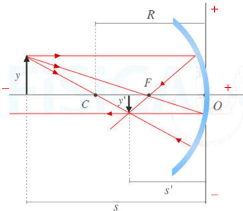
Según el convenio DIN la luz incidente en el sistema óptico procede siempre de la izquierda y se utiliza como origen del sistema de coordenadas el vértice óptico  $O$ , es decir, el punto de intersección del dioptrio o espejo con el eje óptico.
