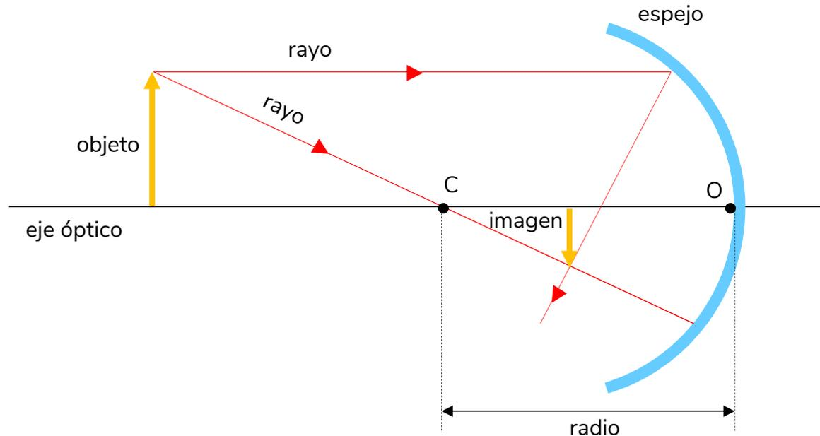
Sistema óptico con espejo que incluye los elementos principales que debes conocer. La trayectoria de los rayos sería distinta si, en lugar de un espejo (que es una superficie reflectora), hubiese un dioptrio (que es una superficie refractora).
