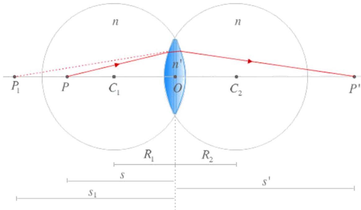
Al ser una **lente delgada**, podemos **despreciar el grosor** de la misma y situar el origen del sistema óptico en el centro de la propia lente.
