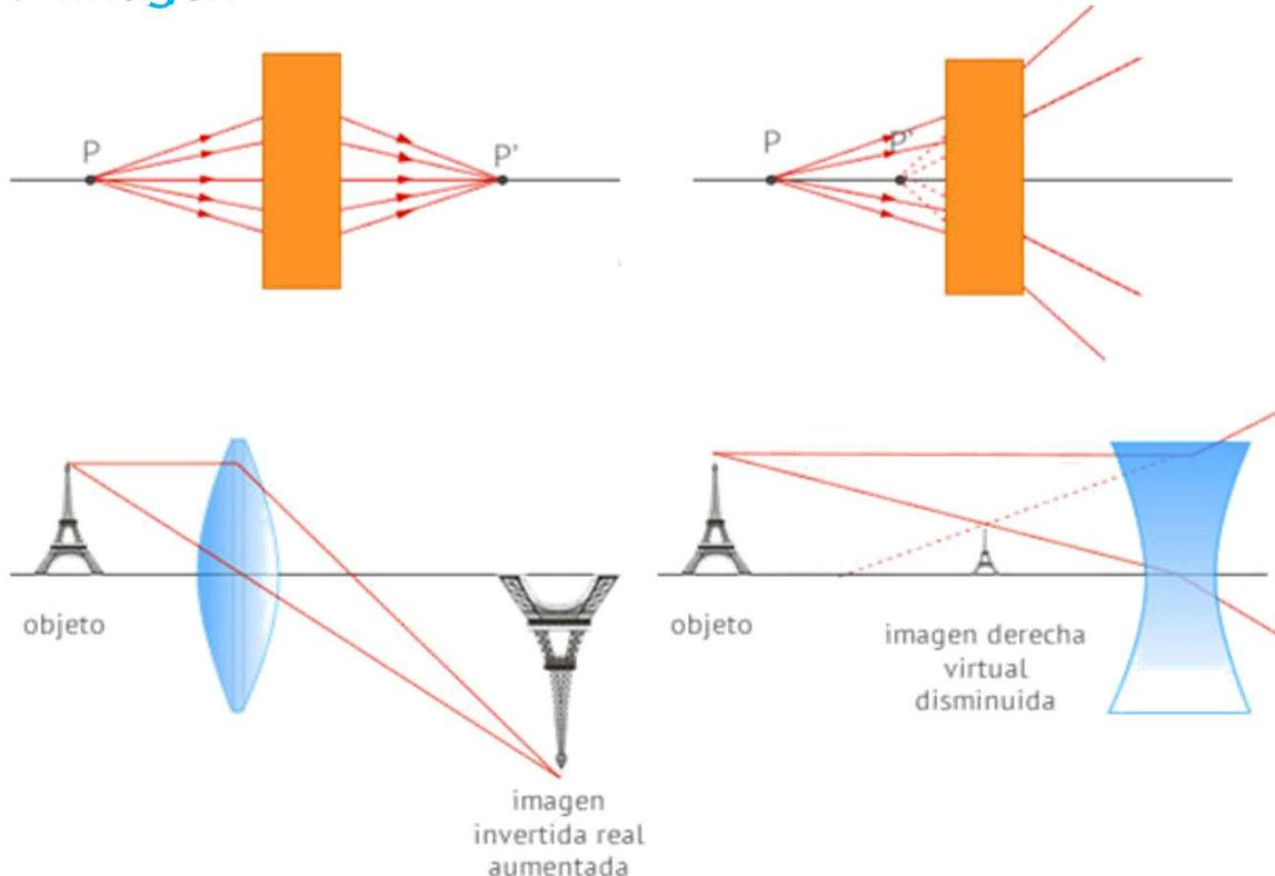
Las dos figuras ilustran claramente la diferencia entre imagen real y virtual. A la izquierda, los rayos procedentes del objeto convergen, tras pasar por el sistema óptico, en el punto  $P'$ , que se considera la imagen de  $P$ . En el segundo caso, los rayos, tras pasar por el sistema óptico, divergen, por lo que la imagen  $P'$  se forma a partir de la intersección de las prolongaciones de dichos rayos.
