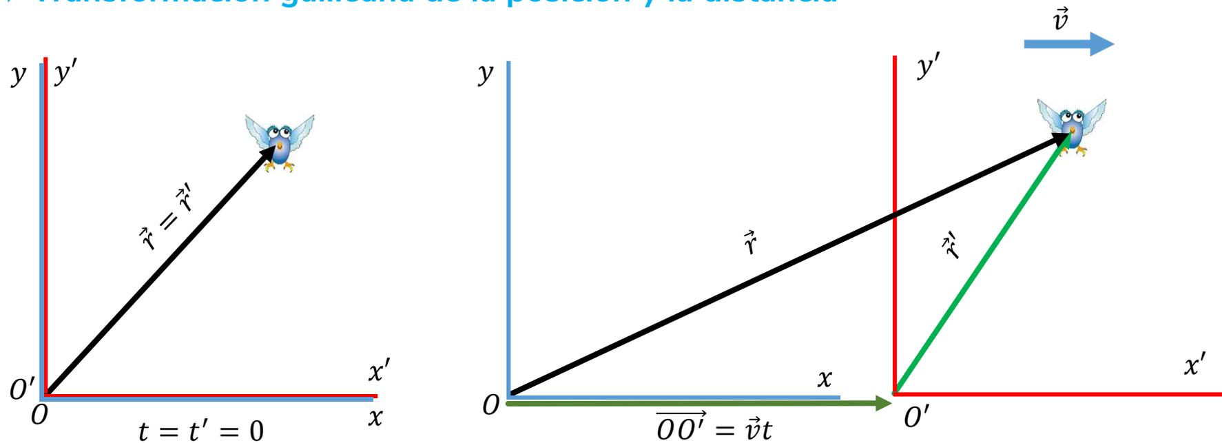
$$\vec{r} = \overline{OO'} + \vec{r}' \quad \longrightarrow \quad \vec{r}' = \vec{r} - \overline{OO'} = \vec{r} - \vec{v}t \quad \longrightarrow \quad \begin{cases} x' = x - vt \\ y' = y \\ z' = z \\ t' = t \end{cases} \quad \text{transformaciones galileanas de las coordenadas}$$
